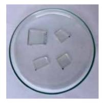
Figura 1: Mostra pedaços de vidro, contendo óxido de índio e estanho (ITO), retirados de displays de LCD de uma calculadora e cortados no tamanho aproximado, de 2 x 2 cm para a construção das CSSCN's.
