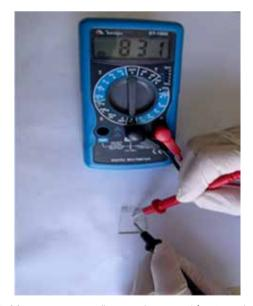
Figura 2: Mostra como medir, usando um multímetro, o lado condutor da placa de vidro contendo óxido de índio e estanho (ITO).
