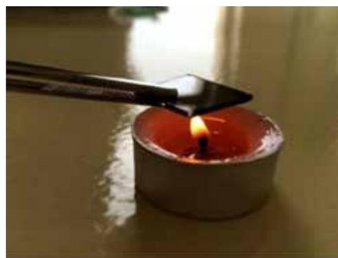
Figura 5: Depósito da camada de carbono (preta) na superfície da placa de vidro condutora (ITO) por meio da queima do pavio de uma vela de parafina.
