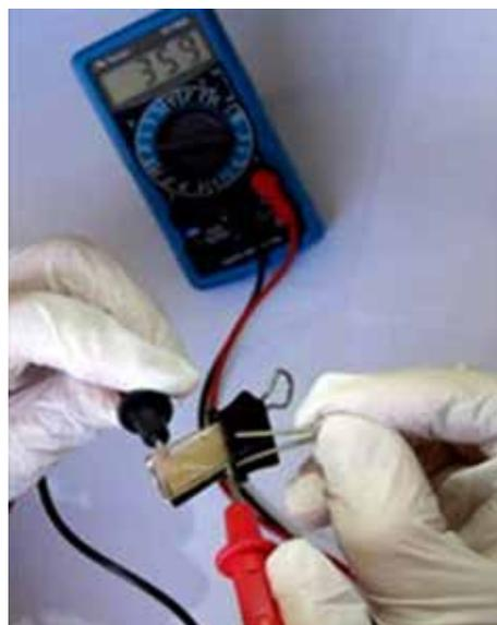
Figura 8: Medida da tensão (359 mV), com um multímetro, da CSSCN produzida com corante (sensibilizador) extraído do vegetal beterraba.
