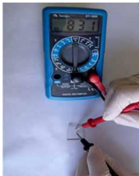
Figura 2: Mostra como medir, usando um multímetro, o lado condutor da placa de vidro contendo óxido de índio e estanho (ITO).
