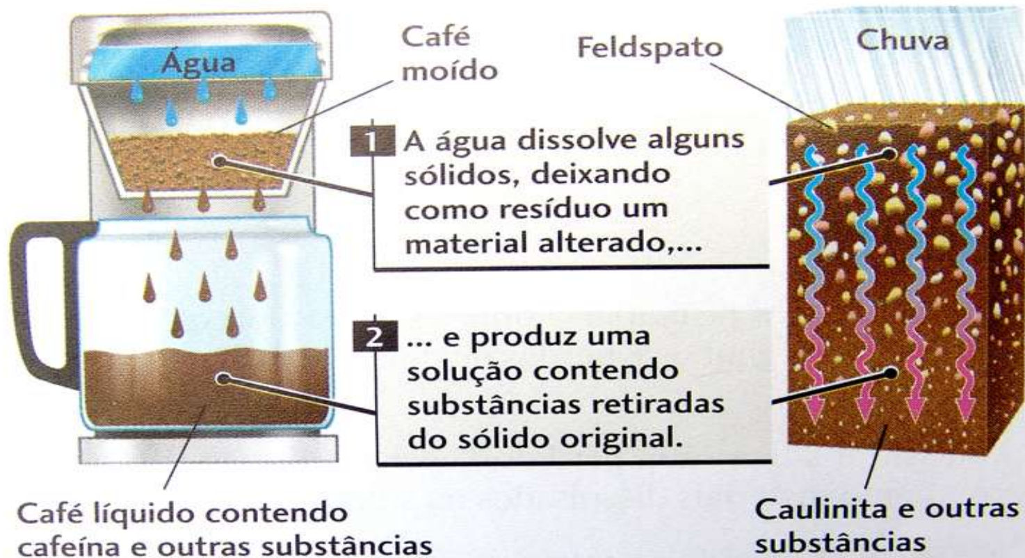
Figura 7.4 O processo pelo qual o feldspato e outros minerais decompõem-se e o soluto acumula-se em níveis mais inferiores do solo é análogo ao de filtragem do café, quando a água, ao passar pelos interstícios do pó, dissolve certas substâncias, deixando para trás um resíduo alterado, e acumula-se com o soluto (cafeína e outros) no recipiente inferior da cafeteira.
