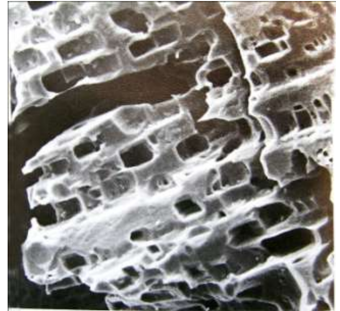
Figura 7.2 Fotomicrografia, obtida por microscópio eletrônico de varredura, de um feldspato marcado e corroído pelo intemperismo químico no solo. [Extraído de R. A. Berner e G. R. Holden Jr., "Mechanism of Feldspar Weathering: Some Observational Evidence", Geology 5 (1977): 369]
