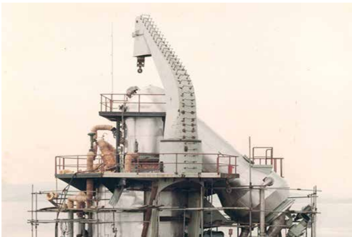
Parte superior do digestor contínuo Kamyrr
