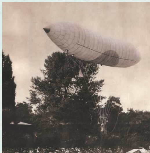
No primeiro balão dirigível que construiu, o nº 1, Santos-Dumont usou um motor a petróleo.
