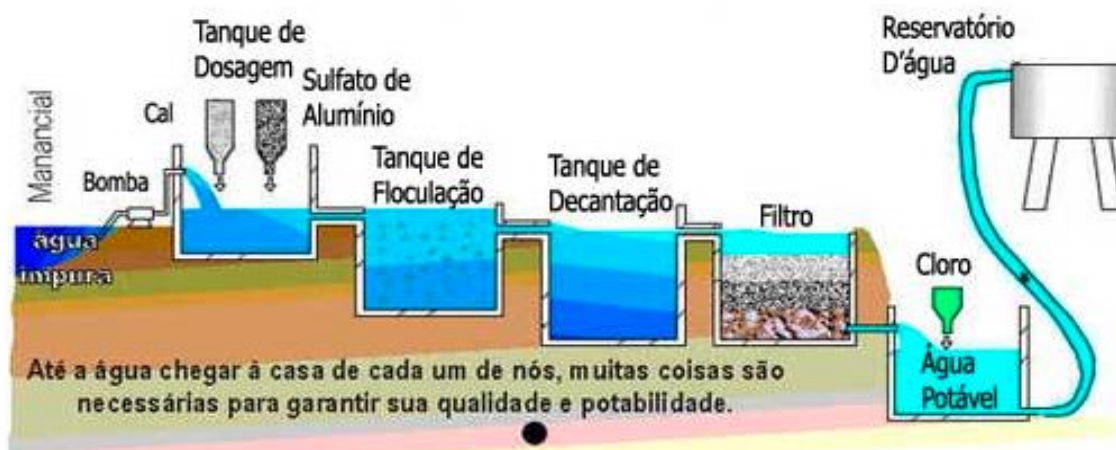
Estação de tratamento de água Esquema simplificado
