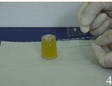
Lamínula com amostra sendo conservada com a parte molhada para cima
