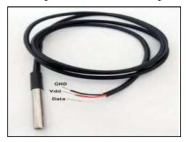
Fig.3: Physical form of DS18B20 & Waterproof Probe
