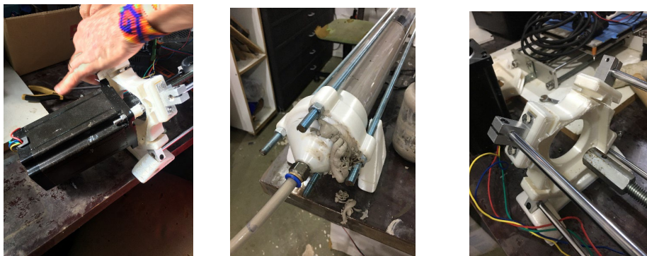
Figura 5, 6 e 7. Mostram as falhas que ocorreram devido às peças impressas não suportarem a pressão na terceira versão da máquina. Fonte: Autor, 2022
