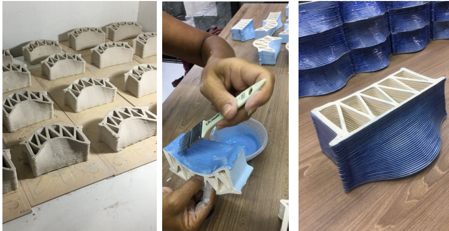
Figura 14, 15, 16. Mostram o processo de fabricação final do bloco, mostrando a peça recém impressa, sendo esmaltada e já queimada. Fonte: Autor, 2022
