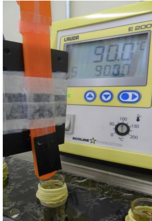
Figura 12 – Fotografia da rede imersa em amostra mantida sob temperatura de (90,00 \pm 0,01) \text{ }^\circ\text{C} em banho térmico.
