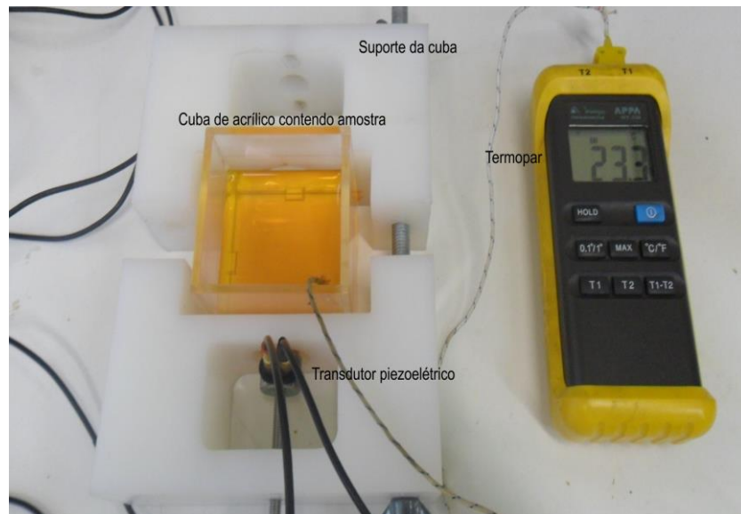
Figura 14 – Fotografia da montagem experimental do sistema de ultrassom.
