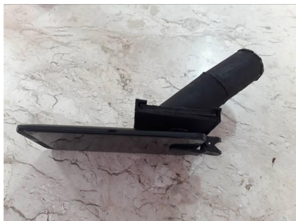
Figura 4: Modelo de espectrômetro feito de madeira.
