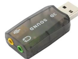
Figura 5 – Adaptador de cabo P2 para USB
