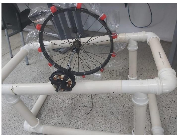
Figura 2. Protótipo montado com aro de bicicleta, eixos e caçapas (topo cortado de garrafas de 600 ml).
