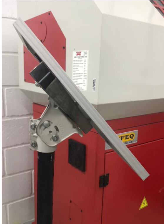
Figura 4. Fixação da placa com suporte de antena.
