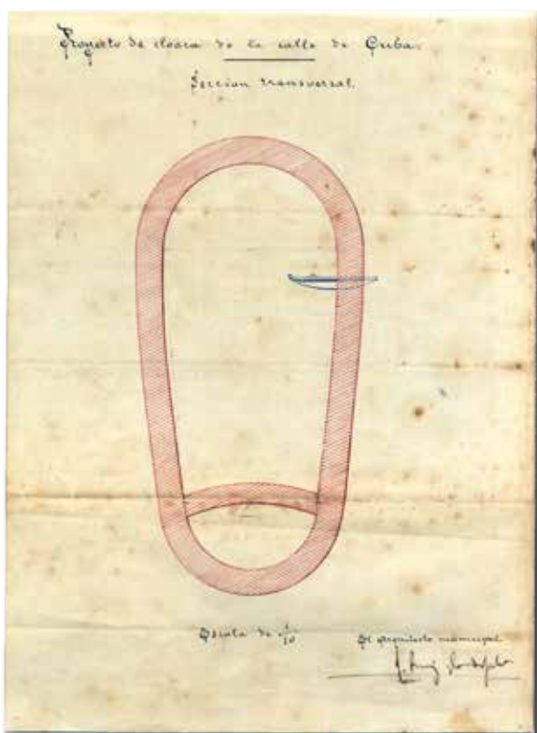
ACM. Fons municipal de Mataró. Projecte de la nova xarxa de clavegueram de Mataró. 1894. Proyecto de cloaca de la calle de Cuba , secció transversal, escala 1:10, firmat per l'arquitecte municipal Josep Puig i Cadafalch: exemple de secció monolítica de formigó en massa. AH.240-01.
